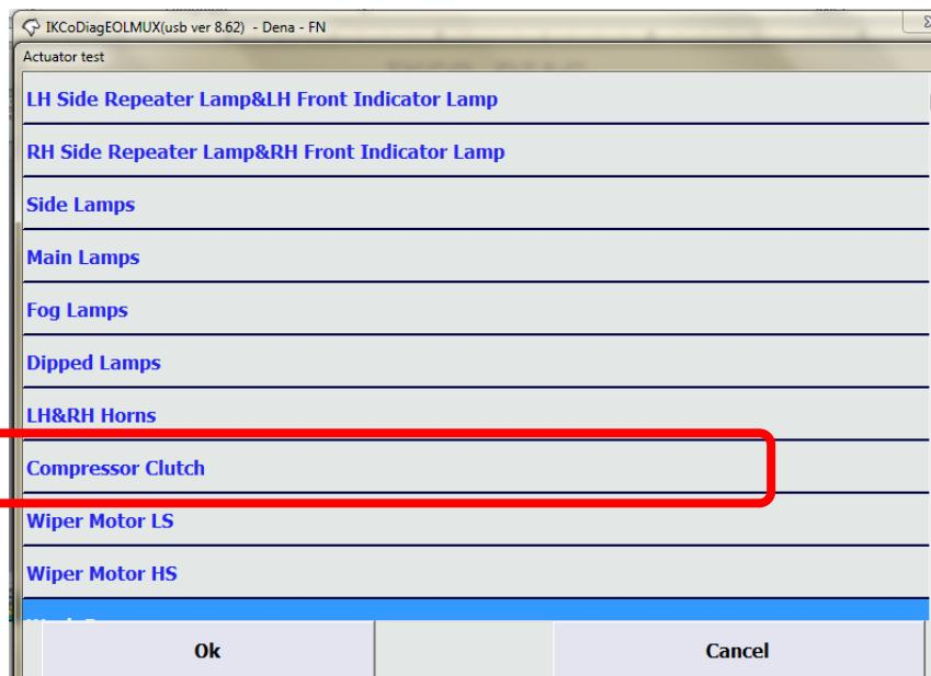
۱- با اتصال دستگاه عیب یاب، از طریق منوی مالتی پلکس خودروی دنا، وارد نود FN و گزینه Actuator Test شوید و اقدام به کمپرسور کولر نمایید. در صورت فعال شدن کمپرسور، قطعه کمپرسور و نود FN سالم است.
