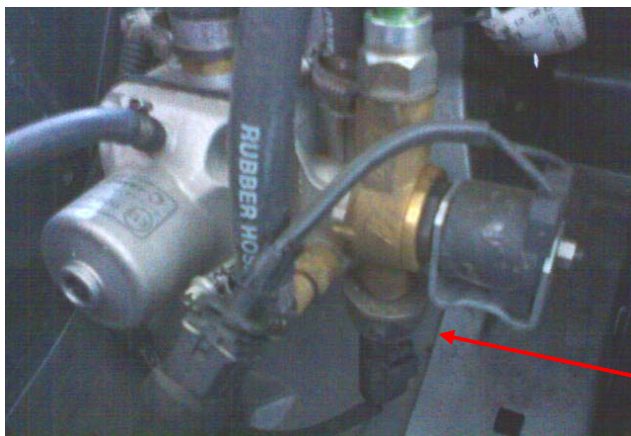
رگولاتور NG1 با سنسور فشار گاز پیزوالکتریک
