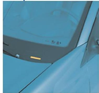
برچسب حاوی کد VIN در قسمت پایین و چپ شیشه جلو اتومبیل نصب شده است.
