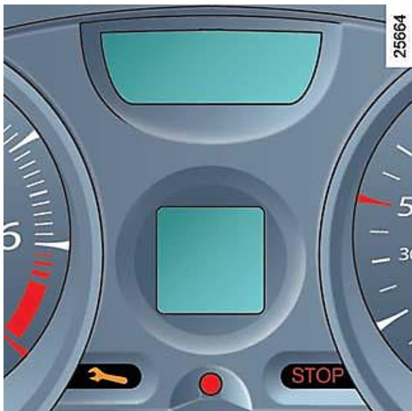
بر حسب مدل خودرو و مشخصات قطعات، وضعیت سیستم ایموبیلایزر توسط یک چراغ قرمز رنگ و بصورت زیر نمایش داده می‌شود:
