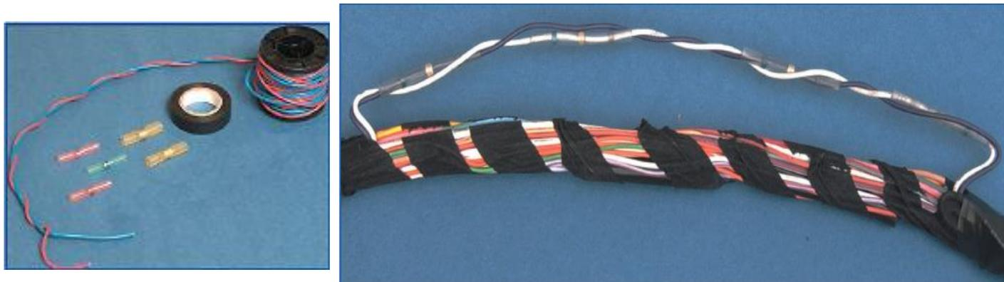
شبکه مولتی پلکس نسبت به کیفیت و سلامت اتصالات الکتریکی و طول سیم ها بسیار حساس می باشد.
